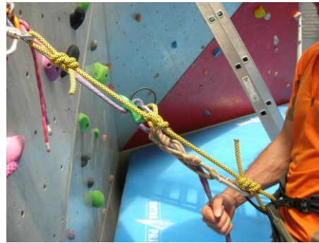
remonter le machard sous le système d'assurage pour être en tension sur le machard afin de libérer la tension sur la vache. Cela permet aussi de vérifier l'efficacité du machard.
